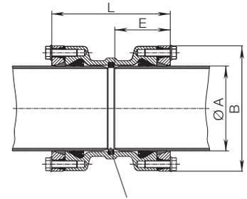
ВНИМАНИЕ! При использовании в качестве подвижной муфты: удалить упорное кольцо и снять наружную фаску на трубе (см. инструкцию по монтажу)
